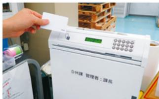
ICカードで開錠し、持ち出しのログが残る仕組み
