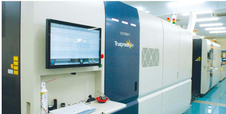
当社主力製品のメーリングパックサービスの発行通数は毎年110%以上の成長率をキープしております。バリエーションDMをよりご活用いただくために、当社主力機である高精細ロール式インクジェット印刷機「Truepress Jet520HD」の増設を決定し、2019年8月に試験稼働を開始いたしました。従来機では選択できなかったコート紙への印刷が可能になり、また近赤外線による効率的な乾燥技術により、高濃度でクリアな仕上がりとなり、印刷品質が向上します。従来機では24時間稼働を行っていましたが、本社工場2台目の導入を果たし、今後はお客様への供給責任を無理なく果たせる体制となりBCP(事業継続計画)の対策強化につながるだけでなく、日中の稼働を上げることで深夜時間の稼働を減らすことができ、働き方改革にも寄与いたします。
