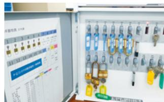
読み込んだICカードによって取り出せる鍵を制御しています
