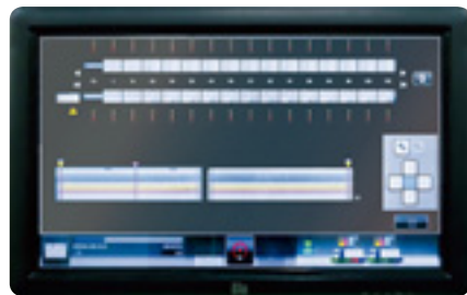
ノズルチェック機能で異常を自動検知し本番印刷前の段取り時間を削減
