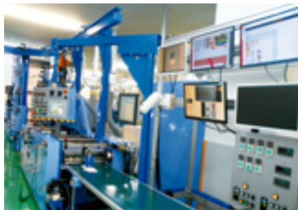
特許技術を搭載した さいたまサテライトの圧着はがき加工機
